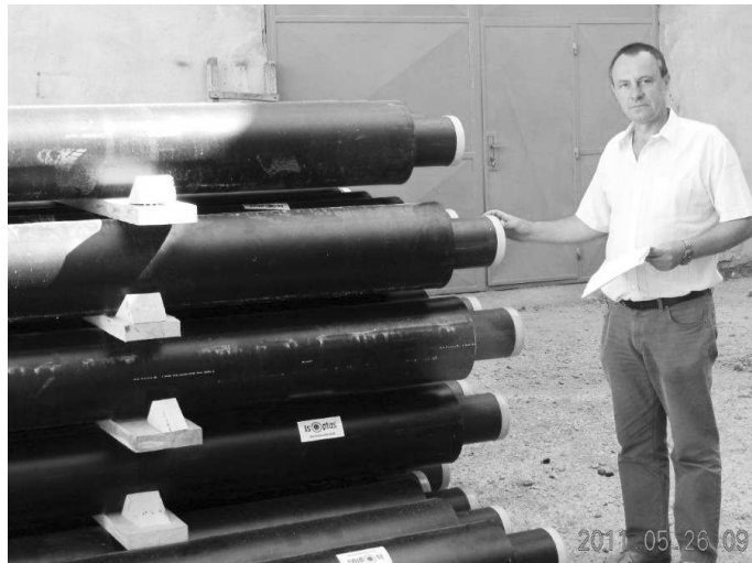
Ing. Stanislav Mojžiš, špecialista na výrobu a distribúciu tepla, kontroluje úplnosť dodávok vopred izolovaných potrubí
